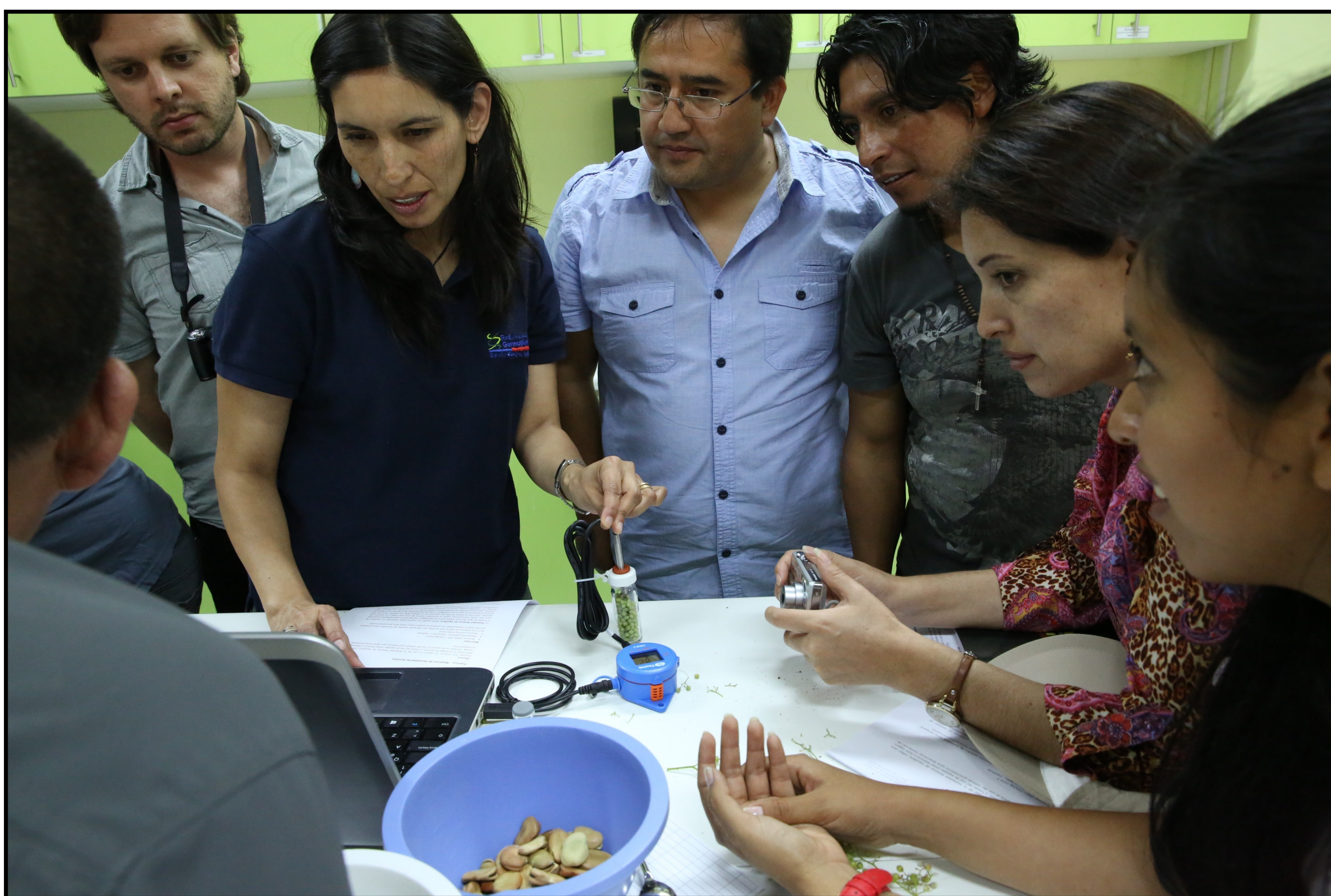
Figura 4. Baixando dados de um higrômetro para determinar o estado de umidade das sementes em um curso de treinamento de 2017. Imagem: Crop Trust - LM Salazar.
